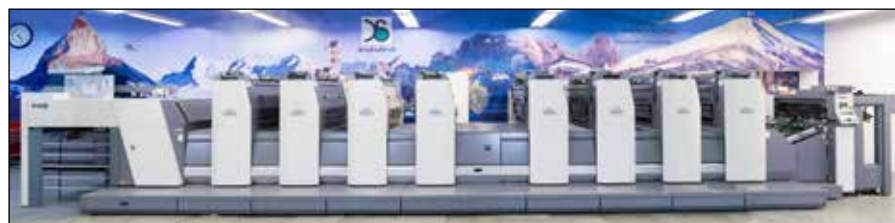
Die Druckerei AG Suhr nutzt das Vulcan Sunrise auf ihrer Ryobi 928 LED-UV für ein breites Sortiment anspruchsvoller Illustrationsdrucke, darunter auch Aufträge mit Verwendung eines 4000 dpi FM-Raster.
