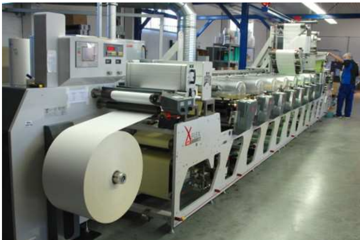
Foto 1: Mit der Achtfarben-Flexodruckmaschine XFlex X4 370 von Omet hat All Labels im August 2014 seine eigene Etikettenproduktion gestartet.
