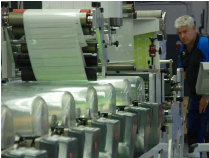
Foto 4: Die Druckwerke der Omet XFlex X4 (maximale Druckgeschwindigkeit 190 m/min) sind dank vollautomatischer Registerregelung sehr schnell einzurichten.
