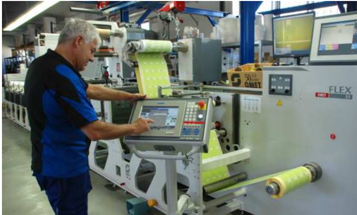
Foto 3: Sorten- oder Auftragswechsel sind mit der intuitiven Bedienung in wenigen Arbeitsschritten zu erledigen.
