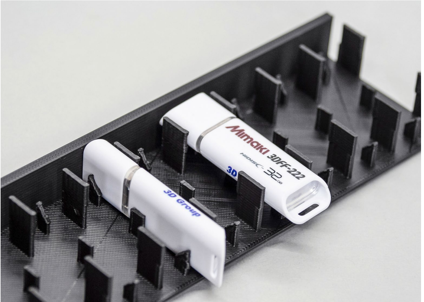
Im 3D-Druck hergestellte Vorrichtung zum Bedrucken von Objekten auf dem Flachbett.
