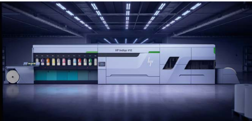
Die V12, erste HP Indigo der sechsten Generation. Das System arbeitet mit einem Drucktuch und ist damit deutlich schneller als alle bisherigen Indigos. Im Druckbereich setzt man nach wie vor auf die E-Ink.
