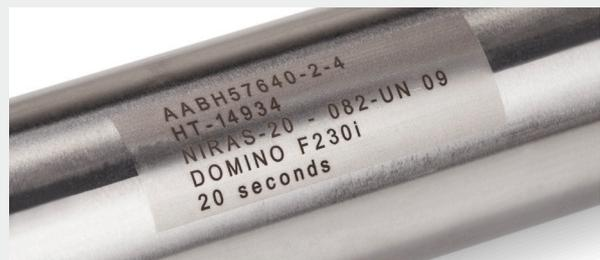
Die Wellenform 0 kann für Gravuren verwendet werden und ist damit ideal für die Markierung von Metallen geeignet
