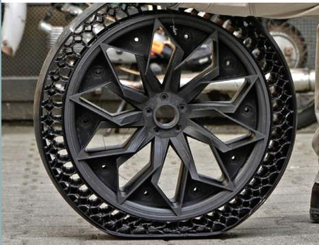
Die schnelle und kosteneffiziente Herstellung von Prototypen eröffnet Entwicklern und Designern neue Möglichkeiten. Die großformatige 3D-Drucktechnologie von BigRep ermöglicht es, eine Vielzahl von Varianten und Iterationen einfach und schnell herzustellen, ohne dabei die Kosten in die Höhe zu treiben. BigRep hat vielen Kunden geholfen, ihre Entwicklungsprozesse vollständig umzustellen, was zu verbesserten Produkten, einer stärkeren Individualisierung und kürzeren Vorlaufzeiten geführt hat.
