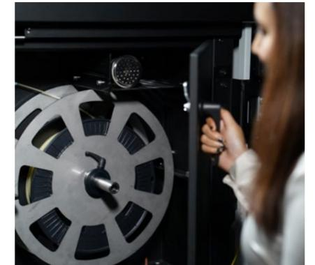
Die abgedichtete Filamentkammer bietet die Möglichkeit, zwei Filamentspulen in einer gegen Umwelteinflüsse abgeschirmten Umgebung zu lagern. Durch Trockenpatronen wird die Luftfeuchtigkeit minimiert, so dass empfindliche Materialien bei gleichbleibendem Trockengrad aufbewahrt werden können.
