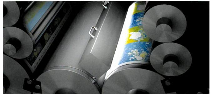
Zwischendeck-UV-Trockner über dem Druckzylinder
