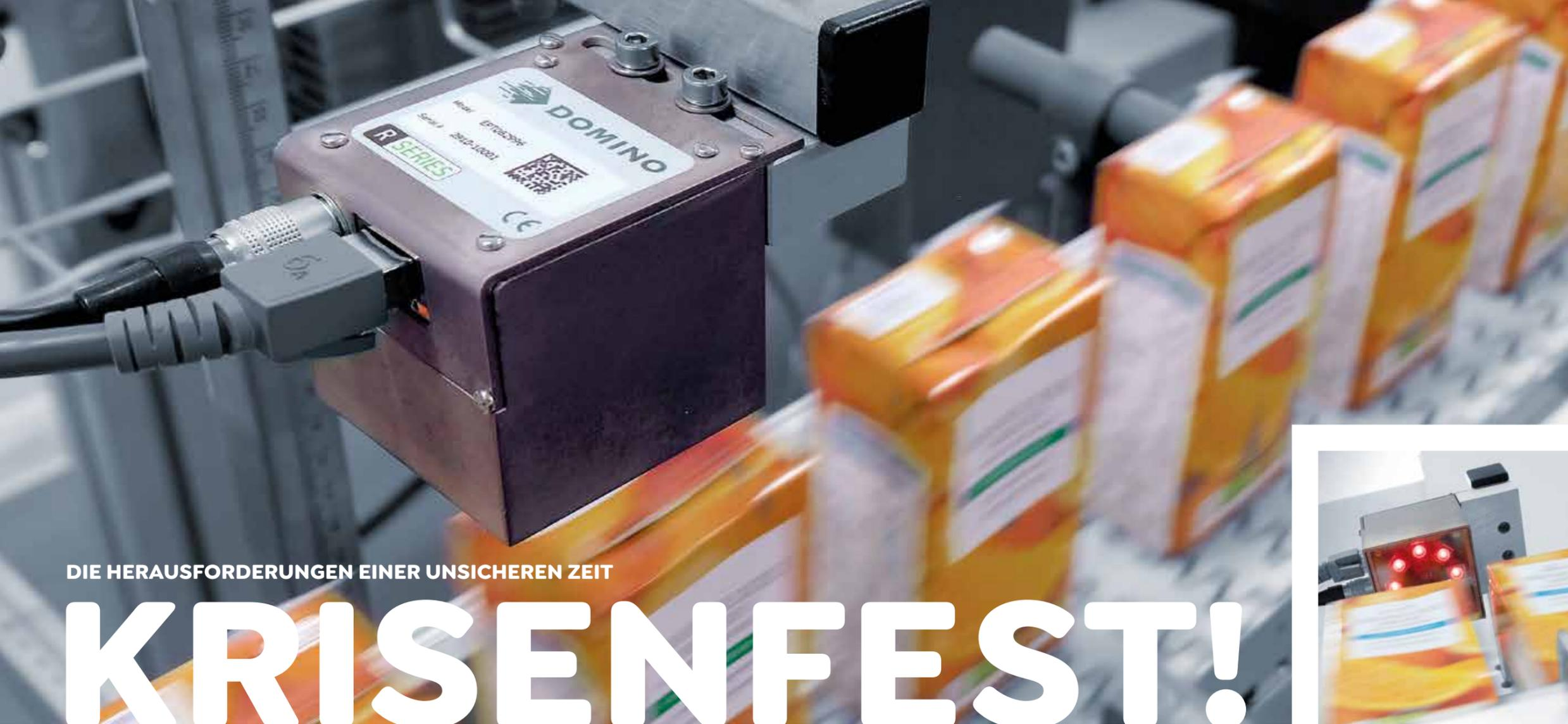
Die Grosszeichendrucker der Cx-Serie drucken direkt grossformatig auf Karton und machen die Verwendung von Etiketten überflüssig. Und KI-gestützte Machine-Vision-Systeme wie die DOMINO R-Serie oder die haus-eigenen Lösungen von CHROMOS Industrial überprüfen Codes mittels Datenbank-abgleich vollautomatisch auf ihre Richtig-keit und vermindern das Risiko von Pro-duktrückrufen.
